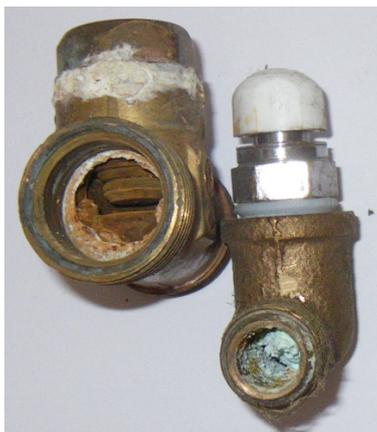
Fussbodenheizungen sind empfindlich gegenüber Luft im Heizsystem, die regelmäßige Überprüfung von Entlüftungen ist wichtig, verkalkte Bauteile, wie hier links zu sehen, gehören in die Altmetallverwertung.
