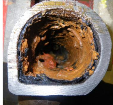
Des weiteren sind im Inneren der Verteiler die feinen Durchgänge in den Ventilen oft zugekalkt, dieses gilt auch für die Entlüfter und andere Bauteile.
