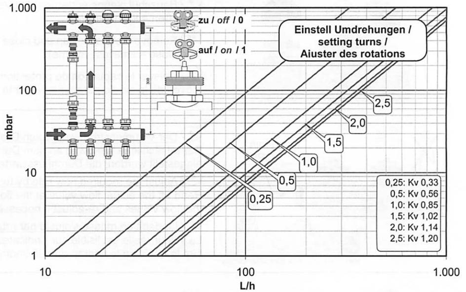
VI. Gesamtdruckverlust / Total pressure drop / Perte de charge totale
